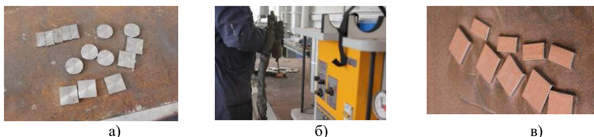
Рисунок 1. Нанесение медного порошка на образцы:
